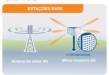
Estação base de setor 4G e estação base 5G com um arranjo de novas antenas MIMO massivas de múltiplos elementos. É previsto que o tamanho físico das antenas das estações base 5G seja similar ao das antenas das estações base 4G
